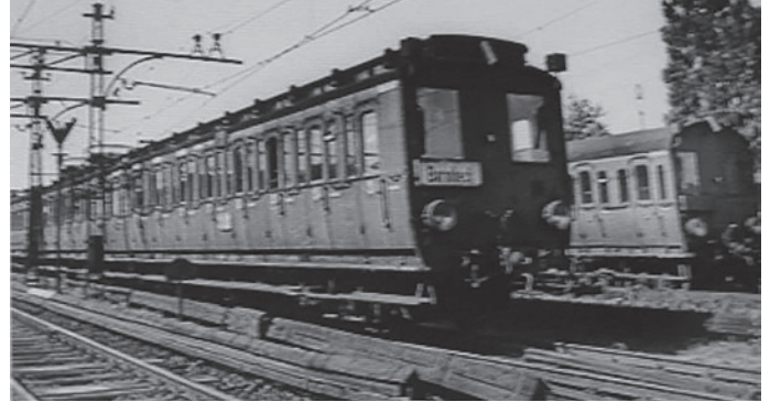
De eerste Serie vun de elektrischen Stadtbahntöög, noch mit een holten Dack un Siedenlüfter buut. Rechts al een Fohrtüüg vun de tweete Serie, ganz ut Stahl buut.
